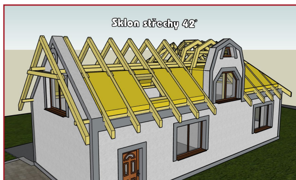
Kontrola rovinnosti a příprava krovu
